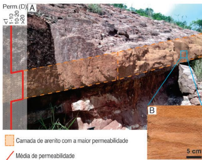
**Figura 7.** Camada C2 com elevados valores de permeabilidade absoluta e distribuição mais uniforme no afloramento (A). Detalhe para a superfície da camada (B), com a capa de alteração e superfície regularizada para melhorar o acoplamento do permeâmetro ao afloramento durante os ensaios in situ.
